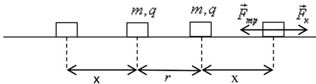
В этот момент времени ускорение становится равным нулю ( $a=0$ ), а скорость каждого тела – максимальной ( $v_{\max}$ ). Для определения этой скорости воспользуемся теоремой об изменении энергии системы:
