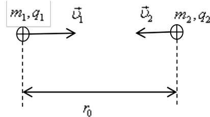
В процессе движения мгновенные силы кулоновского отталкивания будут равны. Из второго закона Ньютона следует, что модуль мгновенного ускорения будет больше у частицы меньшей массы. На некотором расстоянии  $r$  ее скорость становится равной нулю, и она начинает движение в противоположном направлении, совпадающим с направлением движения первой частицы.
